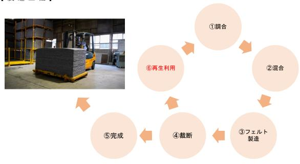
初めに、紡績・不織布・衛生綿などの異なる原料を調合します。 次に、繊維工業から排出されたくずや古着を、バインダー(接着剤) と共に 100 度近い熱で溶かして混合し、1 つの大きな繊維の集合 体を作ります。最後に、調合・混合した原料を熱した後、冷却して フェルトにし、1 つの塊となったフェルトを製品サイズにカットして 完成となります。ここで不良品となったものは、一般的な製法で は廃棄されてしまいますが、当社ではそれらをもう一度機械に で再生・再利用する製法を実現しており、資源を大切にしようとする 当社の努力が表われています。
