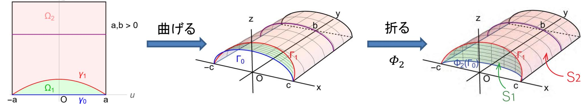
図4: 長方形の紙からピロ一型ボックスを作る. ただし, ボックスの1/4を表示.
