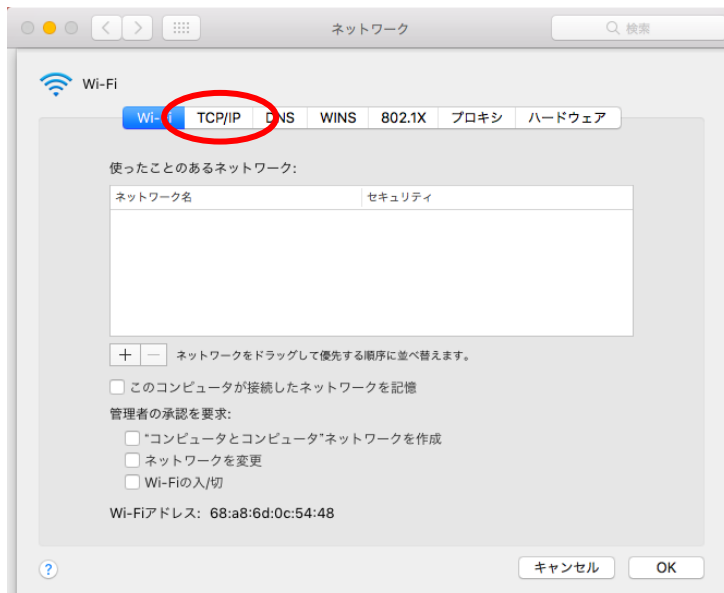
図 2-4 「Wi-Fiの詳細」からのTCP/IPタブの選択
