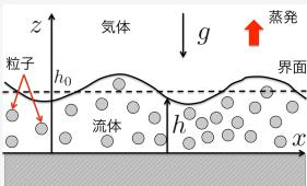
図(2): 水平面壁上に広がった流体のイメージ
