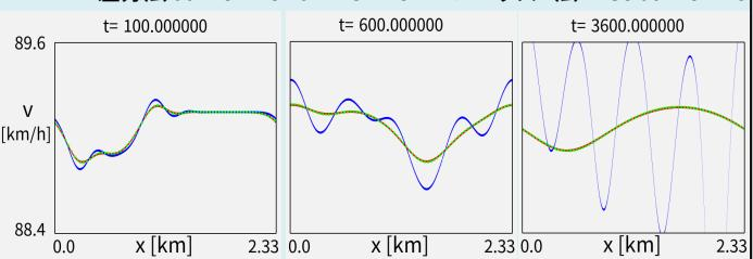
緑の点はOVモデル、赤線はスペクトル法で解いたマクロモデル、青線は差分法で解いたマクロモデルの速度を表している
