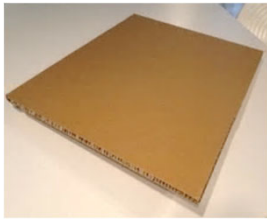
(b)補強用段ボール
