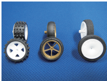
図 18 タイヤ（左からピンスパイク，バレル，スポンジ）
