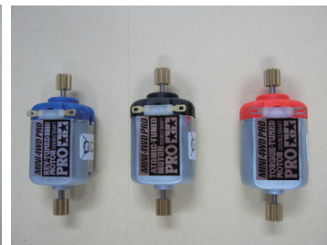
図 17 モーター (左から レブ, アトミック, トルク)
