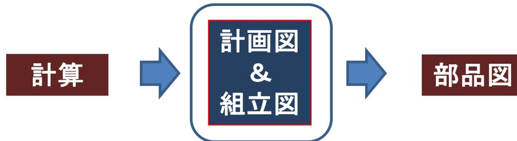
**計画図とは：** 計算で求めた形状、計算では求まらない形状を作図して、製品(エンジン、車両、……)の全体を計画する図面
