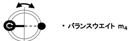
各々の重心までの距離を  $r_1, r_2, r_3, r_4$  とすれば、(1)式から
