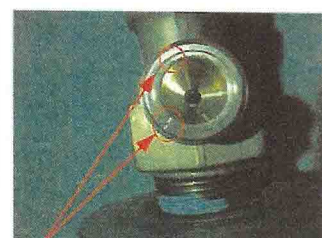
口金の溝を横断する傷がある
