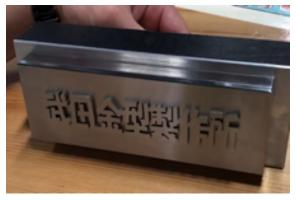
一見何の変哲もないただの鉄塊に見えるこの物体は、後ろにあるネジを回すことで「武田金型製作所」の文字が浮かび上がる、まさに不思議な金属塊です。これは、当社の金属加工技術の結晶で、「武田金型製作所」という文字の部品と、その文字通りにかたどられた台座部品の大きく2つから構成されています。マジックメタルを構成する2つの部品は、非常に精密に加工されており、2つの部品の隙間はわずか3ミクロンほどになっており、一般的な髪の毛のおあるもであずるかります。それほどまでに小さな隙間だからこそ、一見すると何の変哲もない、ただの金属塊のように見えるのです。
