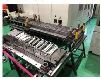
単発型では1つの金型で1つの工程を行い、順送型では1つの金型で複数の工程を行うことができます。写真にある順送型は、短期間で大量につくる際に用いられる金型で、1~2年おきに新たな機種を生み出す、自動車やスマートフォンの部品製造に向いています。上の写真のように平らな型を順番に次の型へと送り、徐々に完成品の形に近づけていきます。1つの部品・製品を作る工程を1つの金型で行うことによって短時間で大量につくることが可能となっています。
