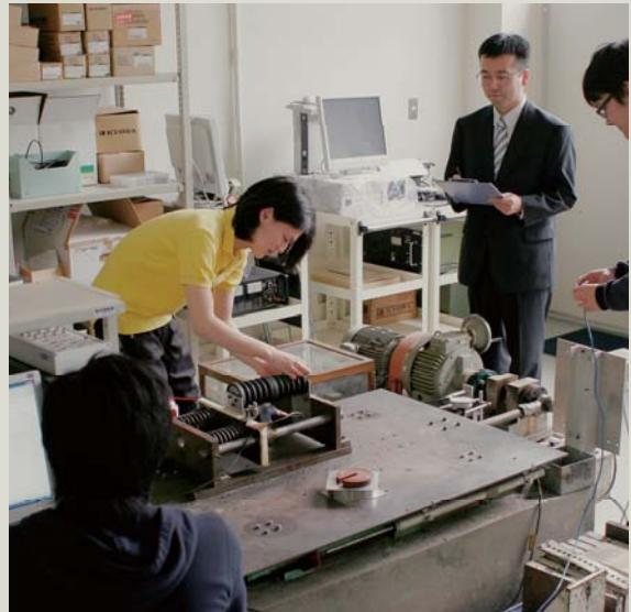
振動を無くすことはできないが、打ち消すことならできる。この研究室でゼミ生と大学院生が行っている研究は、建築物や工業製品を振動から守るための「制振装置」の研究。クルマのサスペンションにも装着されているダンパー（衝撃緩衝装置）の原理を応用して、振動エネルギーを電気信号に変えて地震の揺れを制御するダンパーもつづいている。
