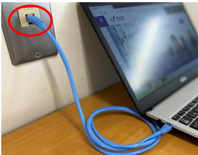
(図 1-1) LAN ケーブルの接続
