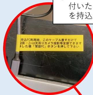
② 挿し換え後、操作卓のパネルでプロジェクター電源をONにし、表示映像選択で「**常設PC**」を選択してください。
