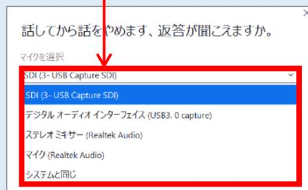
教室スピーカーから着信音が聞こえるか、教室マイクに話した音声の数秒後に教室スピーカーから出力されるかを確認。聞こえない時は、表示されているスピーカー/マイクを切り替えながら順次テストし、正しい機器を選択します。
