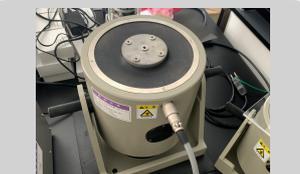
実験で使用した加振機。中心のネジ穴が5つある銀色の部分が上下に振動する
