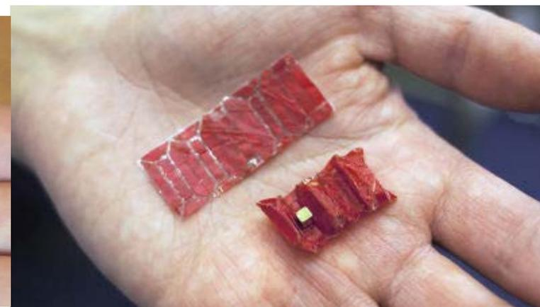
「MIT、シェフィールド大学、東京工業大学」の研究グループが、誤飲した異物を体内から取り除けるようにOrigami Robotを改良。豚の腸を使って作られている。乾燥状態だと左にある紙片のような感じだが、水分を含むと右のような形状に変化して、振動して推進力を得られるロボットに変形。
