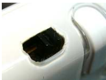
写真 3:速度を切り替えるスイッチはペン収納部の横にある。これで3つの速度を操ることが可能だ。
